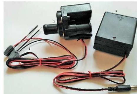
Технические характеристики: Размер электроклапана: 90x70x70мм. Диаметр присоединительных штуцеров электроклапана 20мм. Пропускная способность клапана до 80%. Давление в водопроводе от 0 до 2 атмосфер. Блок питания с батареями АА. Светодиодный индикатор влажности. Длина кабеля щупов – 2 м. Вес комплекта: 0,8кг. Алкалиновые батареи работоспособны 1,2 года.
